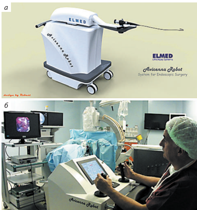
Рис. 14. Аппаратный комплекс для выполнения робот-ассистированной гибкой уретероскопии «Avicenna Roboflex» (ELMED, Анкара, Турция) (а), консоль управления (б)
