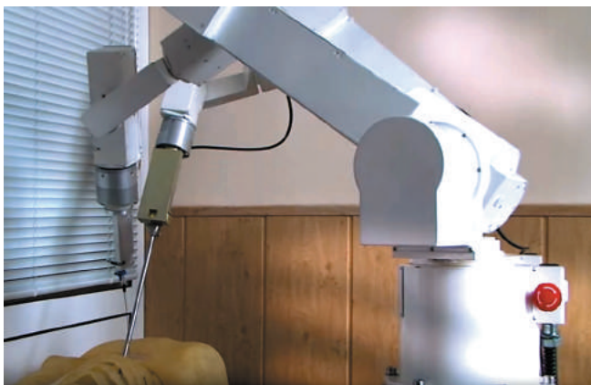
Рис. 15. Прототип отечественного робота-манипулятора для выполнения уретероскопии
